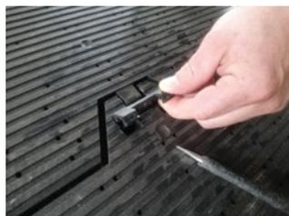
Рис. 22 Демонтаж фиксирующих заглушек отверткой
