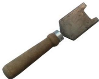
Рис. 21 Ключ для демонтажа заглушек
