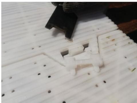
Рис. 23 Демонтаж фиксирующих заглушек ключом
