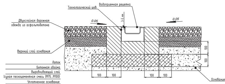
Схема монтажа водоотводного лотка **Ecotek STANDART 100.95 H 99** в поверхность из асфальтобетонного покрытия. Класс нагрузки **B 125**.
