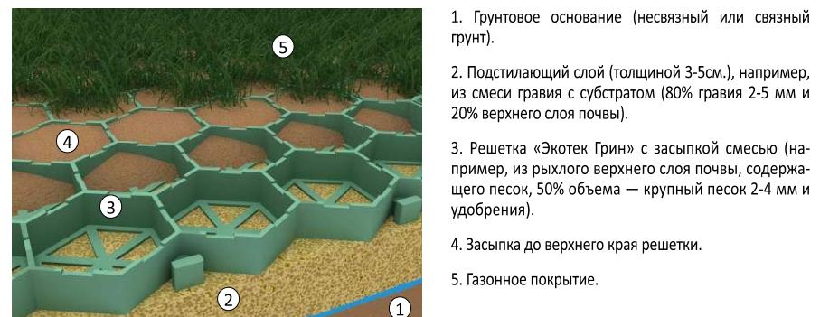
Конструктивная схема экопарковки с зеленым покровом с использованием решетки «Ecoteck Parking»
