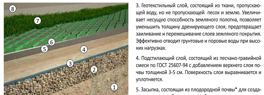
1. Грунтовое основание, имеющее выровненную поверхность с отклонением от требуемой высоты +/- 2 см и отклонением от плоскости в пределах замерного участка длиной 4 м — не более 2 см, состоящее из уплотненного грунтового основания, степень уплотнения которого не должна превышать 90%.
